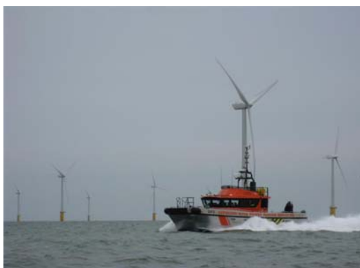
Parque eólico de Thanet, (parque eólico costa afuera mas grande del mundo), a 12km dentro del mar del Norte, en la costa de Kent, 100 turbinas Vestas V90 de 3MW cada una, para un total de 300 MW. Fue contruido en 100 días, una turbina por día, y es propiedad de Vattenfall.
